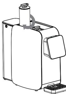
Otočte filter v smere hodinových ručičiek, uistite sa, že je filter pevne na svojom mieste a vložte späť horný kryt.
